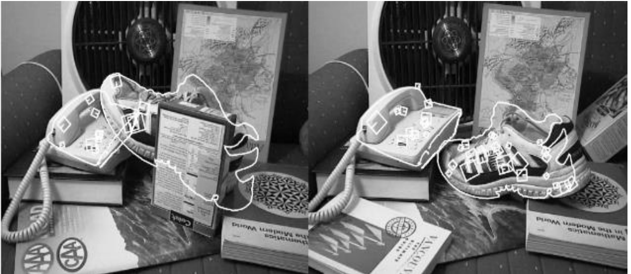
Рис. 2.8 – Об'єкти, представлені локальними ознаками SIFT, демонструють високу стійкість до просторовим перетворенням, і оклюзії
