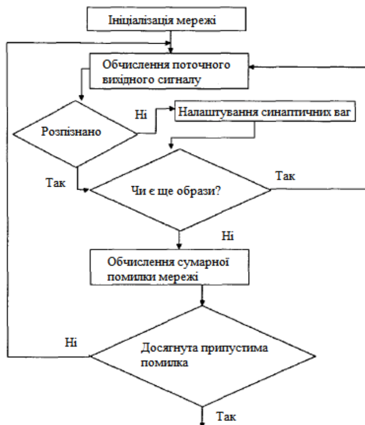
Рис 2.10. Схема навчання мережі зворотного поширення
