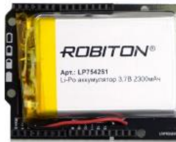
Рисунок 3.5 – Монтажна реалізація Battery Shield 2
