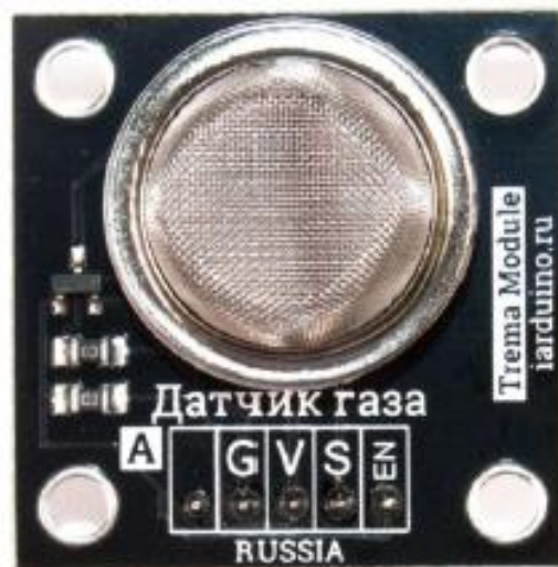
Рисунок 3.9 – Монтажна реалізація елементної бази датчик газу MQ-2
