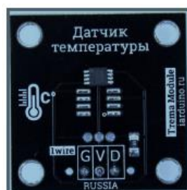
Рисунок 3.7 – Монтажна реалізація елементної бази цифрового термометру
