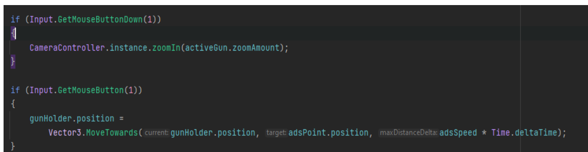
Рисунок 3.11 — Секція коду з реалізацією зближення та віддалення прицілу
