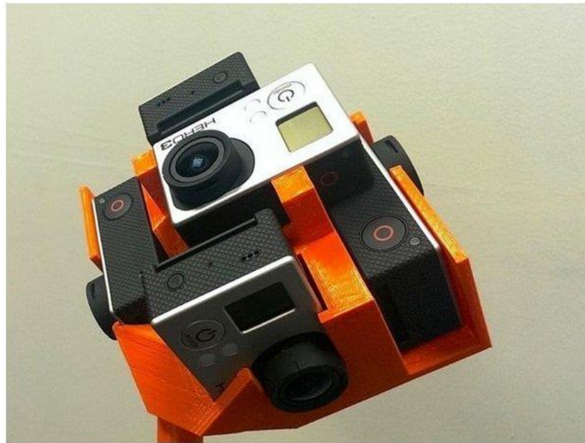
Рисунок 3.7 – Рама для сферичної зйомки з використанням кількох Hero3 – Black Mount
