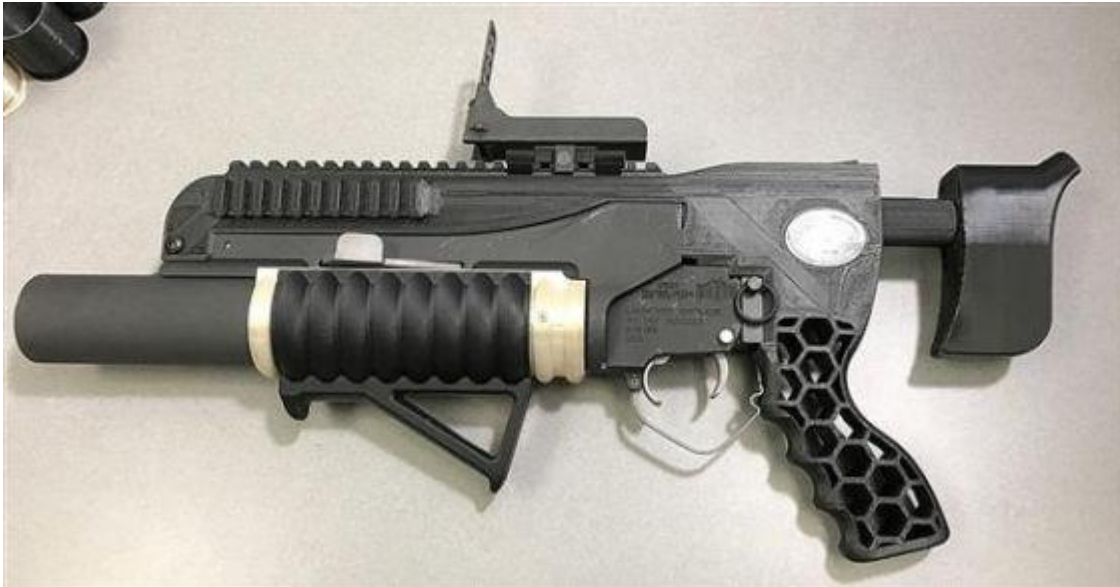
Рисунок 3.41 – дослідний зразок гранатомета RAMBO (Rapid Additively Manufactured Ballistics Ordnance), що складається з 3D-друкованих деталей з металу та різного типу пластику
