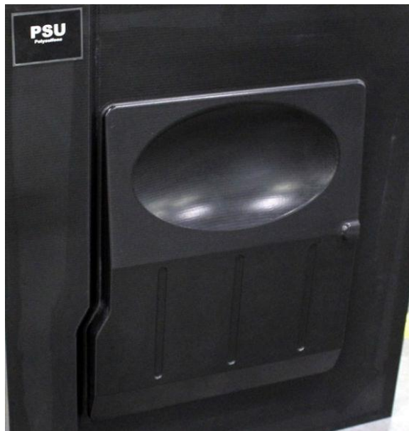
Рисунок 3.40 – 3D-друкарська панель із PSU американського військового вертольота Chinook компанії Boeing
