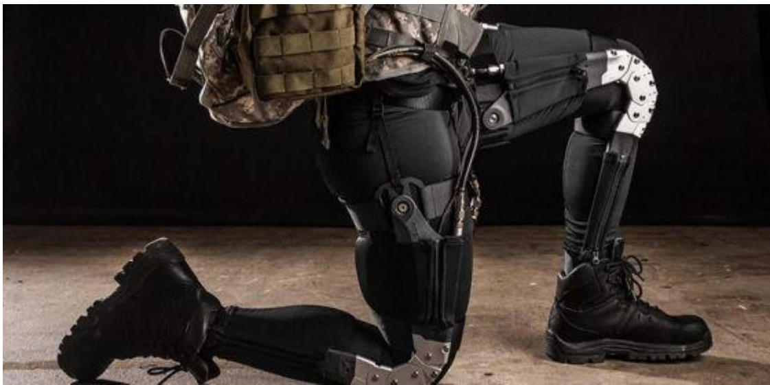
Рисунок 3.34 – Надруковані деталі екзоскелета піхотинця компанії Lockheed Martin
