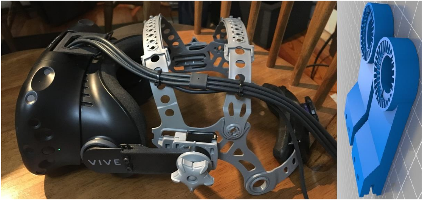
Рисунок 3.12 – Деталі для з'єднання VR-шолома HTC Vive з зручнішим, ніж комплектне, кріпленням на голову
