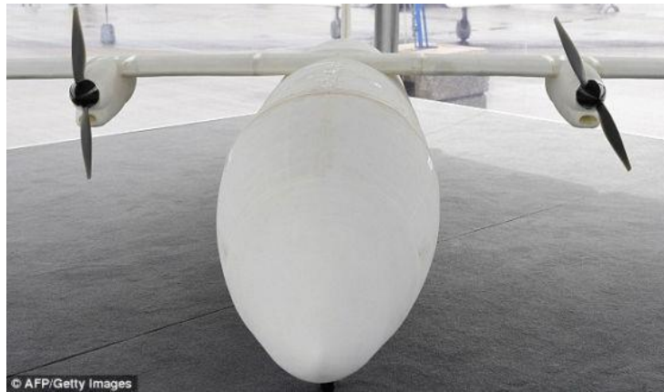
Рисунок 3.35 – безпілотний літальний апарат Thor компанії Airbus, що при довжині близько 4 метрів важить всього 21 кг.
