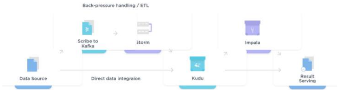
Рисунок.1.13. - Архітектура Kudu для оптимізації конвеєра даних та підвищення швидкості запитів і аналітики.
