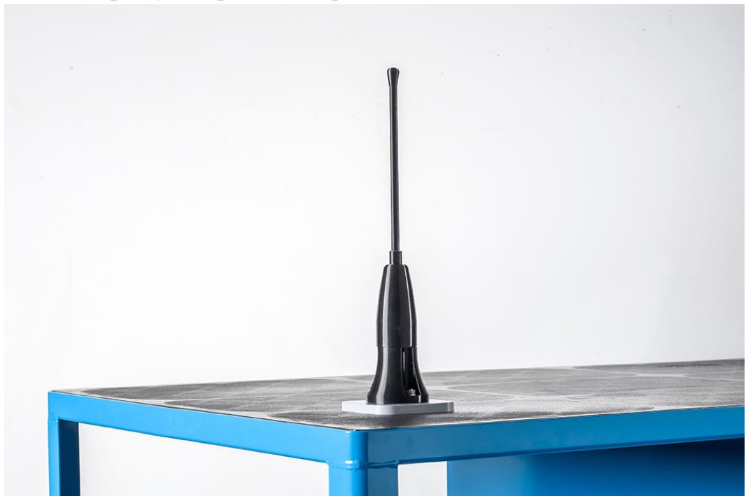
Рисунок 3.2 – Зміцнений корпус антени для захисту її від зриву
