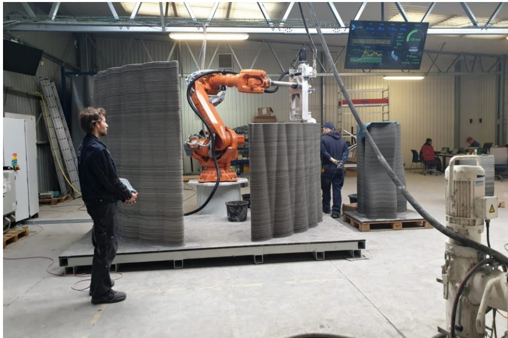
Рисунок 3.1 – Друк бетонних стін за допомогою 3D-принтера
