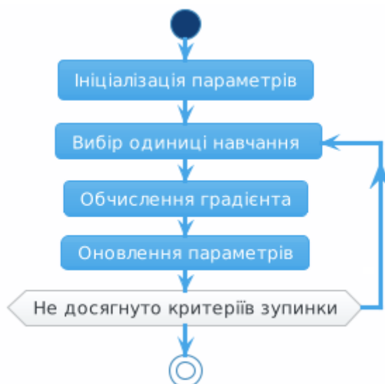
Рисунок 2.2 – Схема роботи алгоритму СГС
