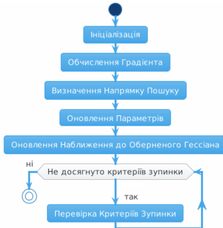
Рисунок 2.1 – Схема роботи алгоритму БФГШ
