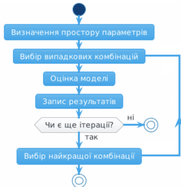
Рисунок 2.3 – Схема роботи алгоритму МВП
