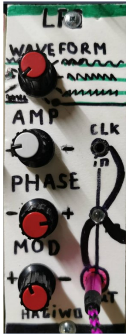
Рисунок 2.15 - CLOCK SYNC LFO генератор наднизької частоти.
