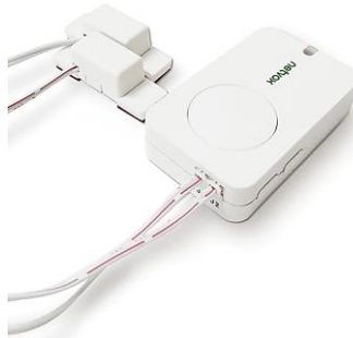
Рисунок 2.13 – Сенсор протікання води Netvox R311W
