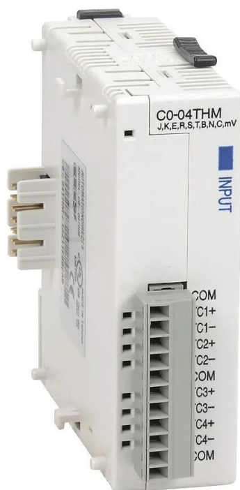
Рисунок 1.15 PLC для управління опаленням
