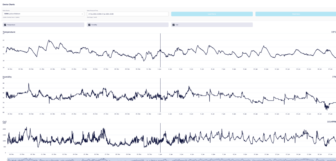
Рисунок 3.7 - Синхронізовані графіки пристрою котрий містить датчики температури, вологості і вуглекислого газу
