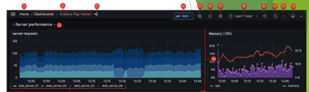
Таблиця 6.2 – Створення і налаштування графіків та панелей для моніторингу MQTT даних в Grafana
