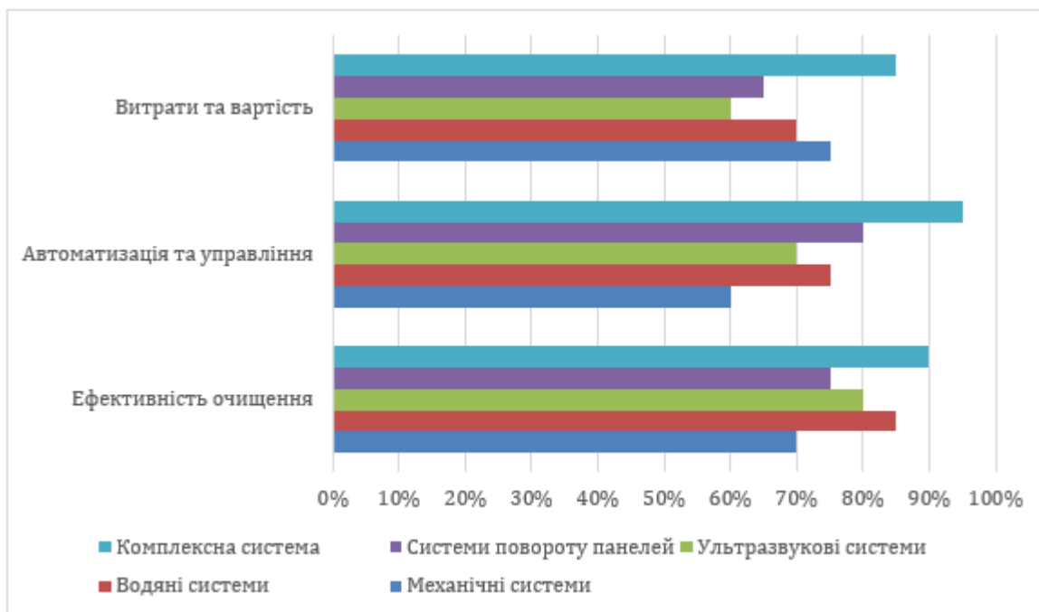
Рисунок 3.1 – Порівняння ефективності звичайних систем очистки та комплексної системи
