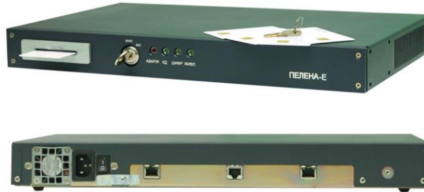
Рис.2.10. Комплекс криптографічного захисту інформації Пелена-Е
