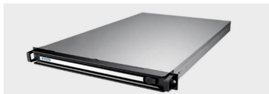
Рисунок 3.4 – Масштабований сервер SKY-6100 з двома процесорами Intel® Xeon® в стійці 1U
