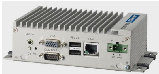
Рисунок 3.6 – Універсальний без вентиляторний комп'ютер Advantech UNO-2272G
