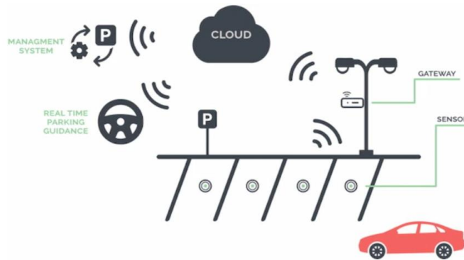
Рисунок 2.3 – Схема компонентів в розумній системі паркування з використанням IoT
