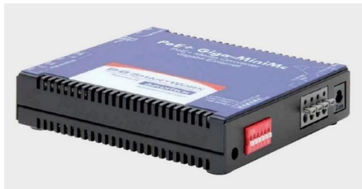
Рисунок 3.3 – Медіаконвертер з підтримкою технології PoE Advantech ІМС-390-SE-US
