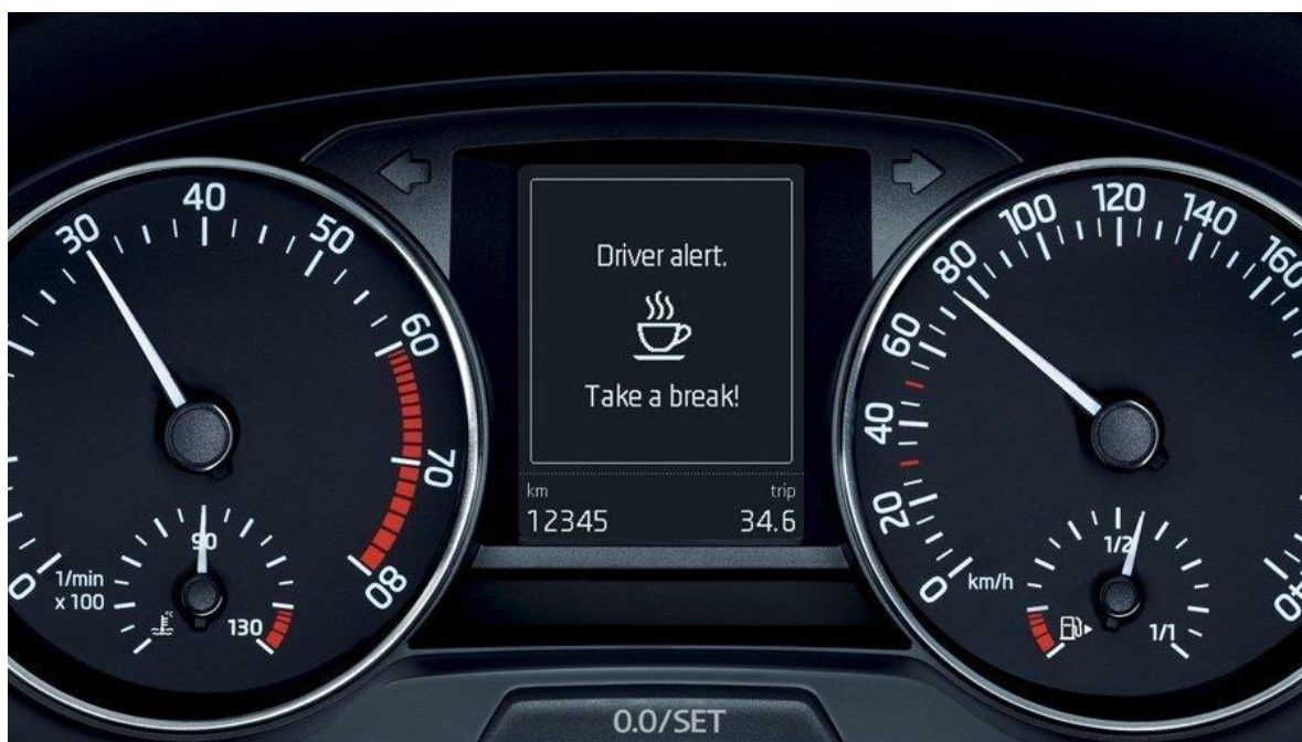
Рисунок 1.2 – Концепція роботи системи Audi «Rest Recommendation»
