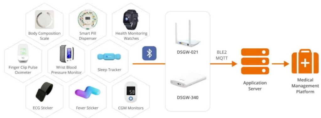
Рис. 2.7. Схема пристроїв віддаленого моніторингу пацієнтів за допомогою IoT
