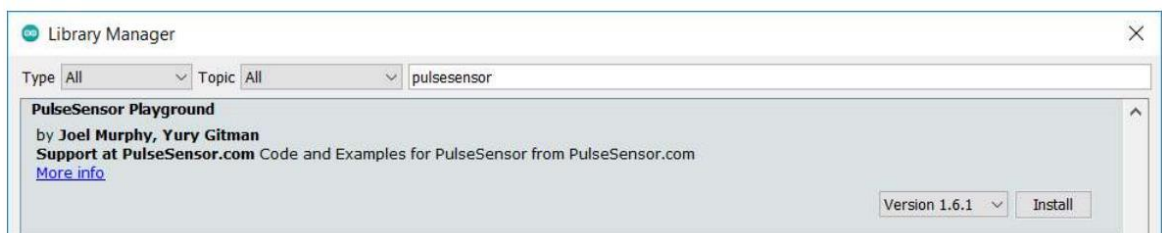
Рис.3.6. Процедура додавання зовнішньої бібліотеки PulseSensor в середовище розробки Arduino IDE
