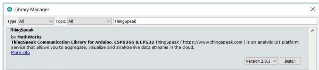
Рис.3.28. Процедура додавання бібліотеки для взаємодії з платформою ThingSpeak
