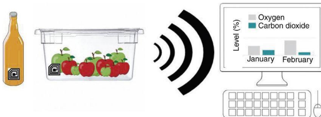
Рис. 2.2 Розумна упаковка на основі технології RFID для контролю якості харчових продуктів. [13]
