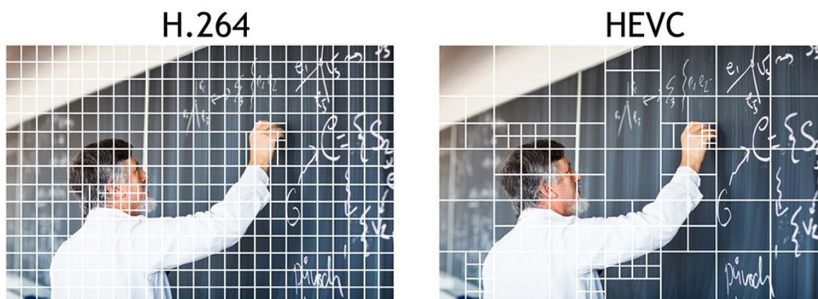
Рис. 2.4 Відмінність блоків кодування в кодеках
