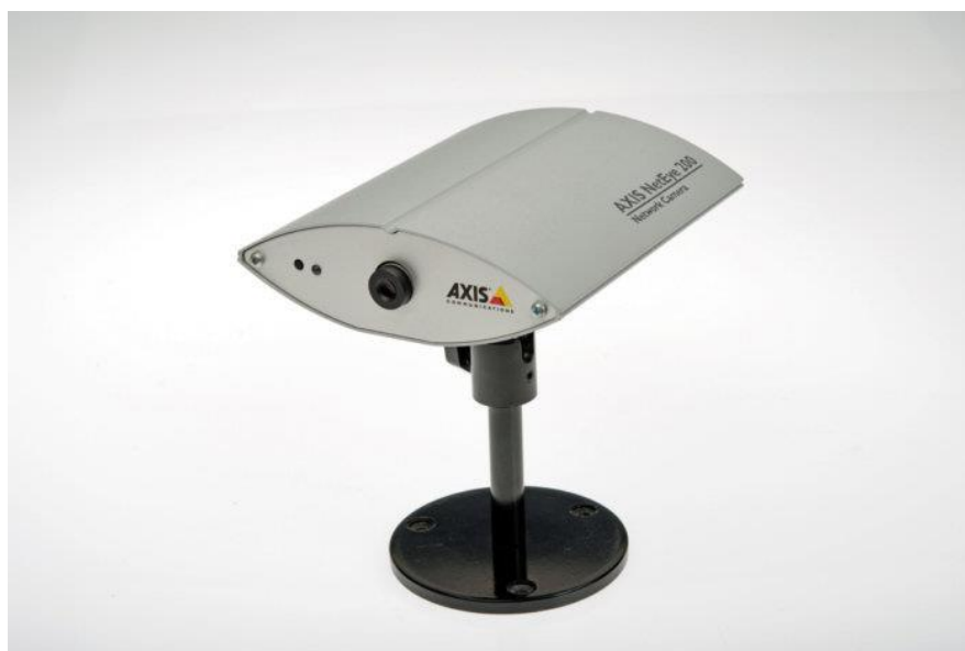
Рис. 1.1 Перша IP-камера в світі Neteye 200 [5]
