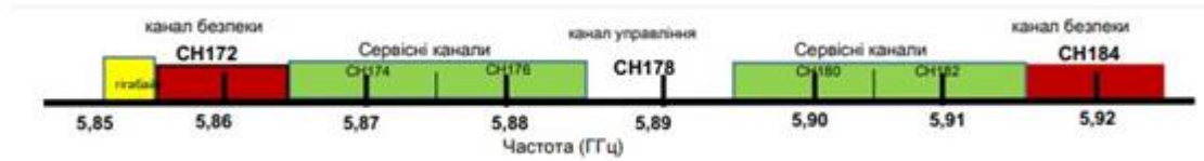
Рисунок 1.7 – Частотний діапазон каналів IEEE 802.11 p
