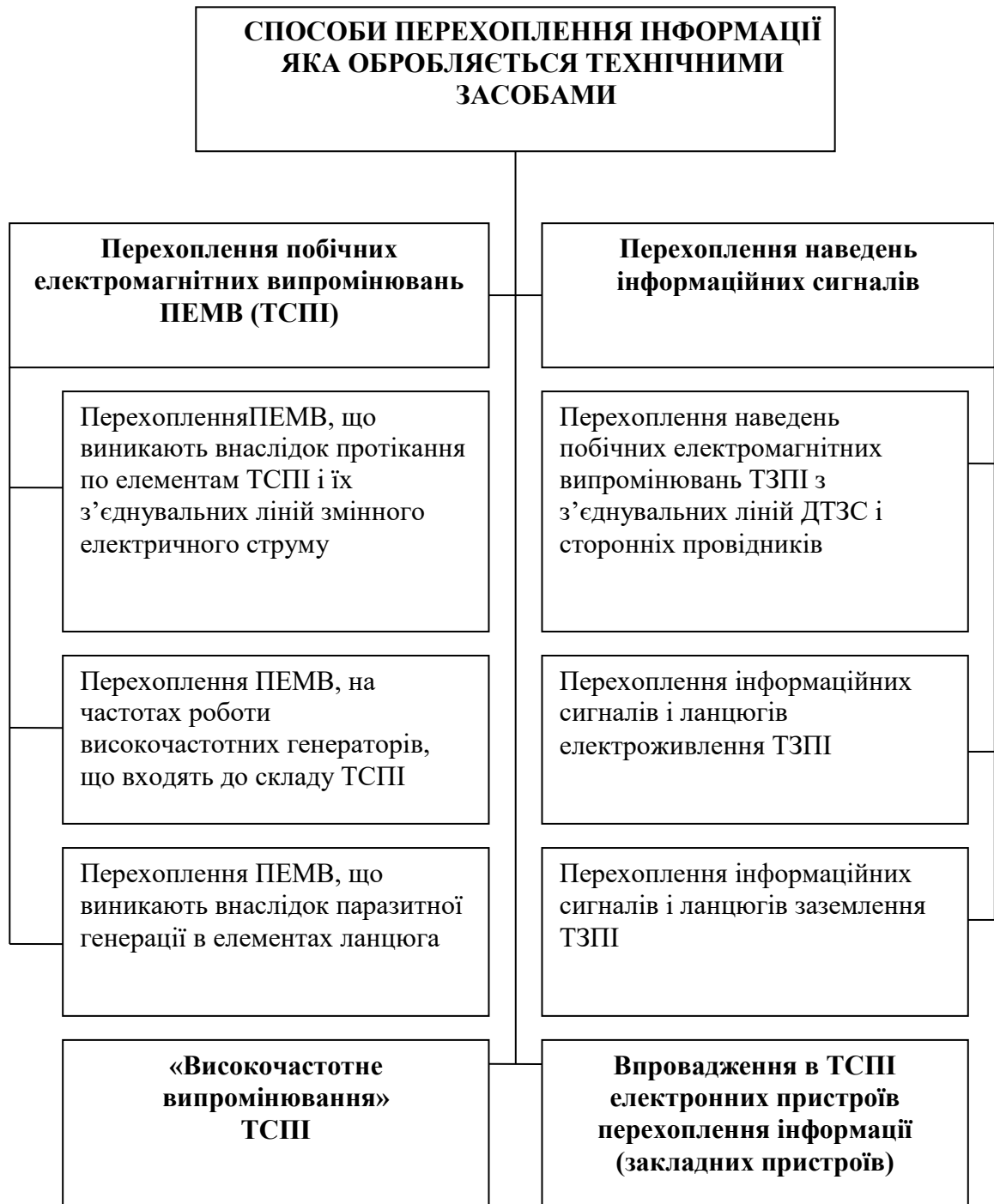
Рис. 1.2. Класифікація способів перехоплення інформації, що обробляється технічними засобами
