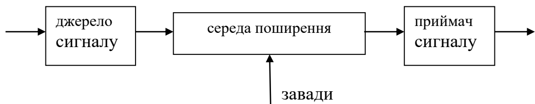
Рис. 1.1. Структура радіоканалу витоку інформації
