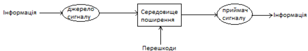
Рис.1.2. Структура радіоелектронного каналу
