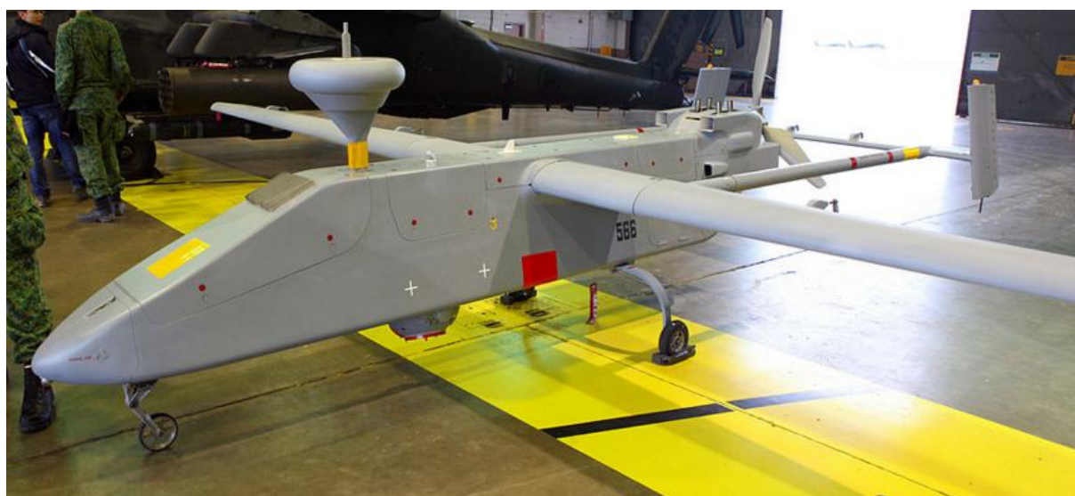
Рисунок 1.5 – Тактичний розвідувальний БПЛА багаточільового призначення типу «Searcher MKII» (Ізраїль)
