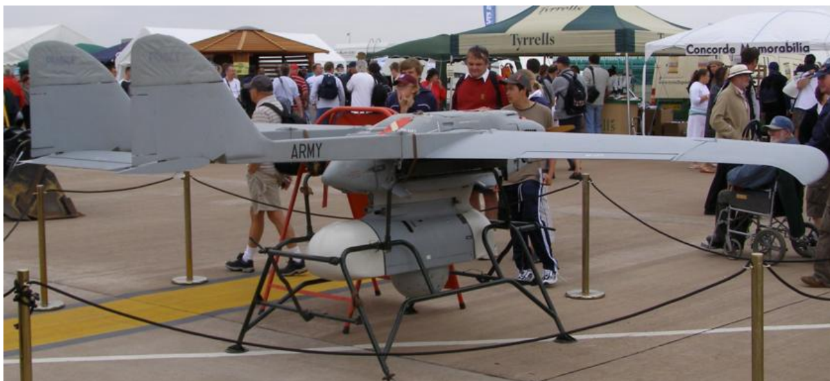
Рисунок 1.6 – Тактичний розвідувальний БПЛА багатоцільового призначення типу «Phoenix» (Великобританія)
