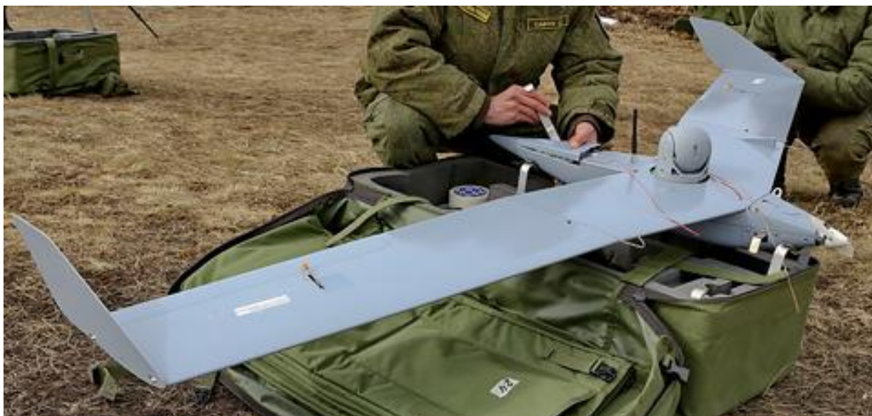
Рисунок 1.2 – Тактичний міні-БПЛА поля бою типу «Bird Eye-400» (Ізраїль)
