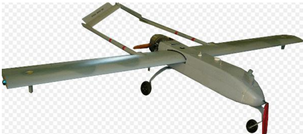
Рисунок 1.4 – Тактичний розвідувальний БПЛА багаточільового призначення типу RQ-7 «Shadow-200» (США)
