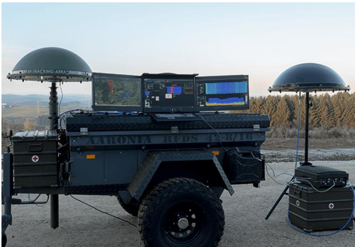
Рисунок 1.16 – Система пасивної локації "Drone Detector" від компанії Aaronia
