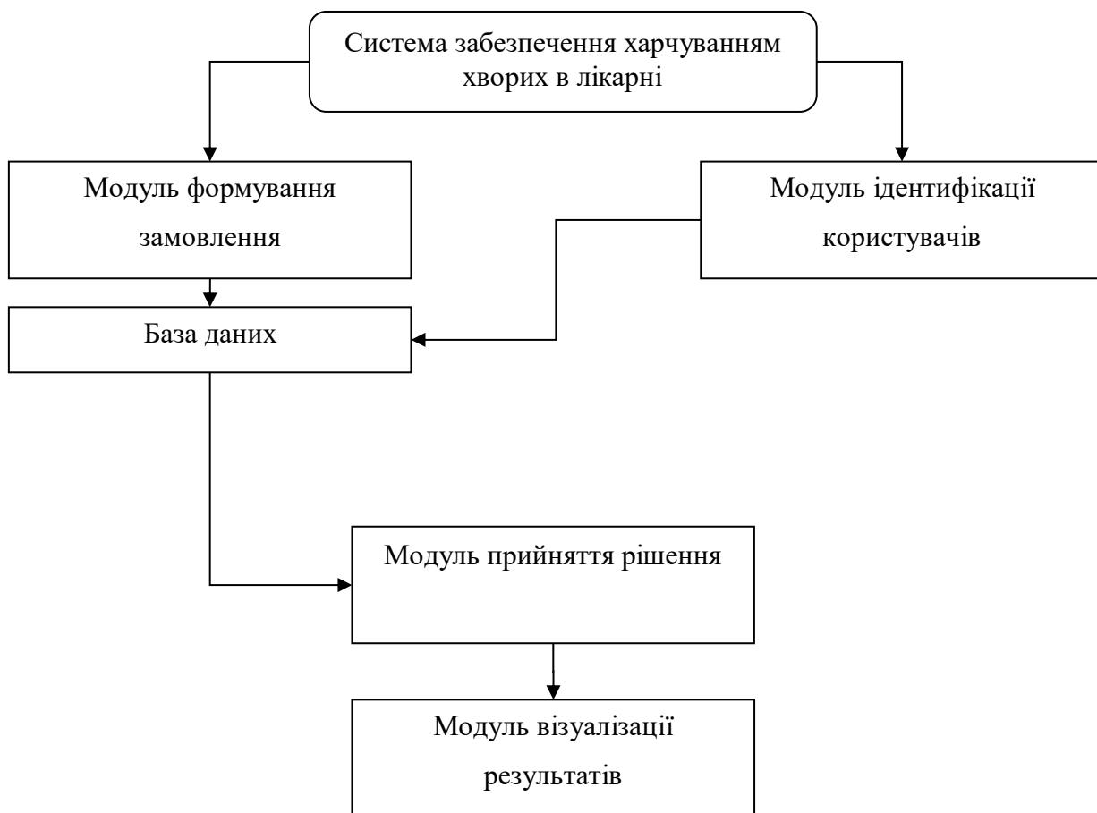
Рисунок 2.1 – Структурна схема системи забезпечення харчуванням хворих в лікарні
