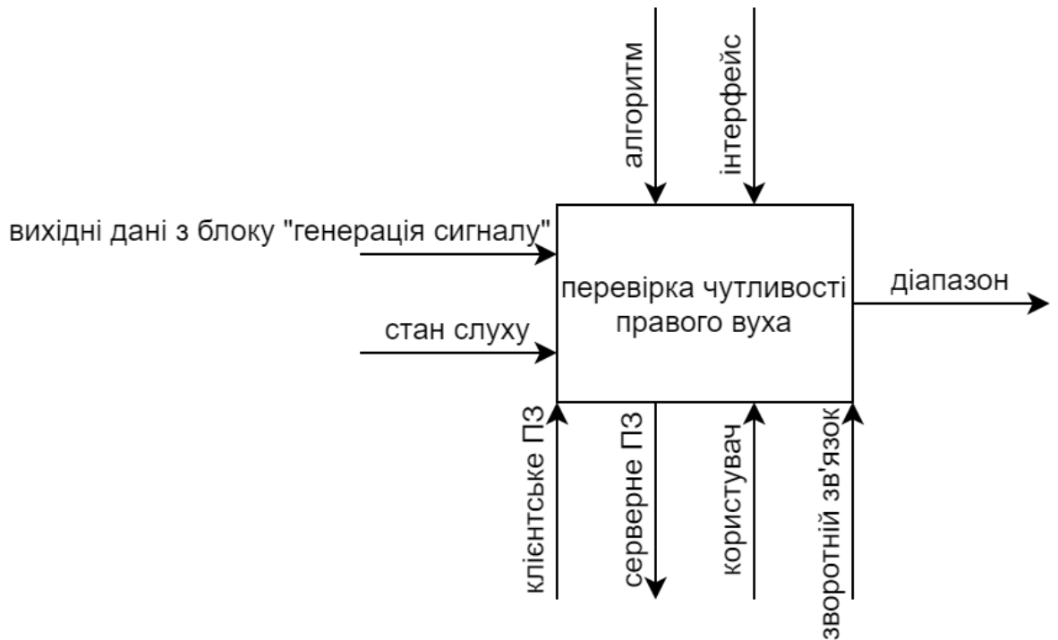
Рисунок 4.10 – Схема декомпозиції блоку В1.3 «перевірка чутливості правого вуха» у нотації IDEF0
