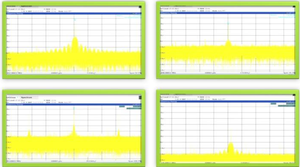
Рис. 2. Фотографії спектрограм сигналів відеотракту ПЕОМ у ближній зоні при дослідженні побічних електромагнітних випромінювань
