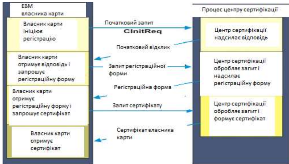
Рис. 2.4 Схема аутефекації платежу
